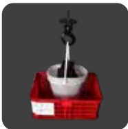
塑膠手把60kg 拉力測試
